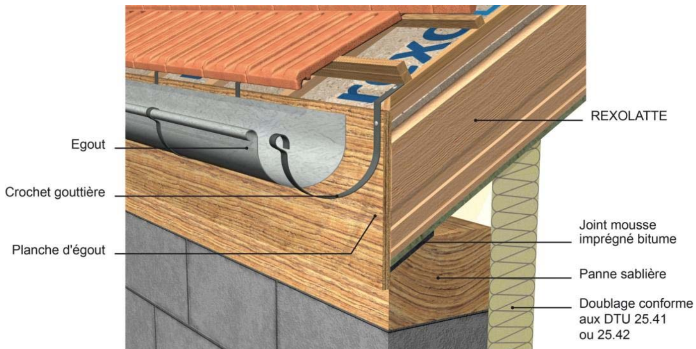
Figure 7 – Réalisation d'égout sans débord
