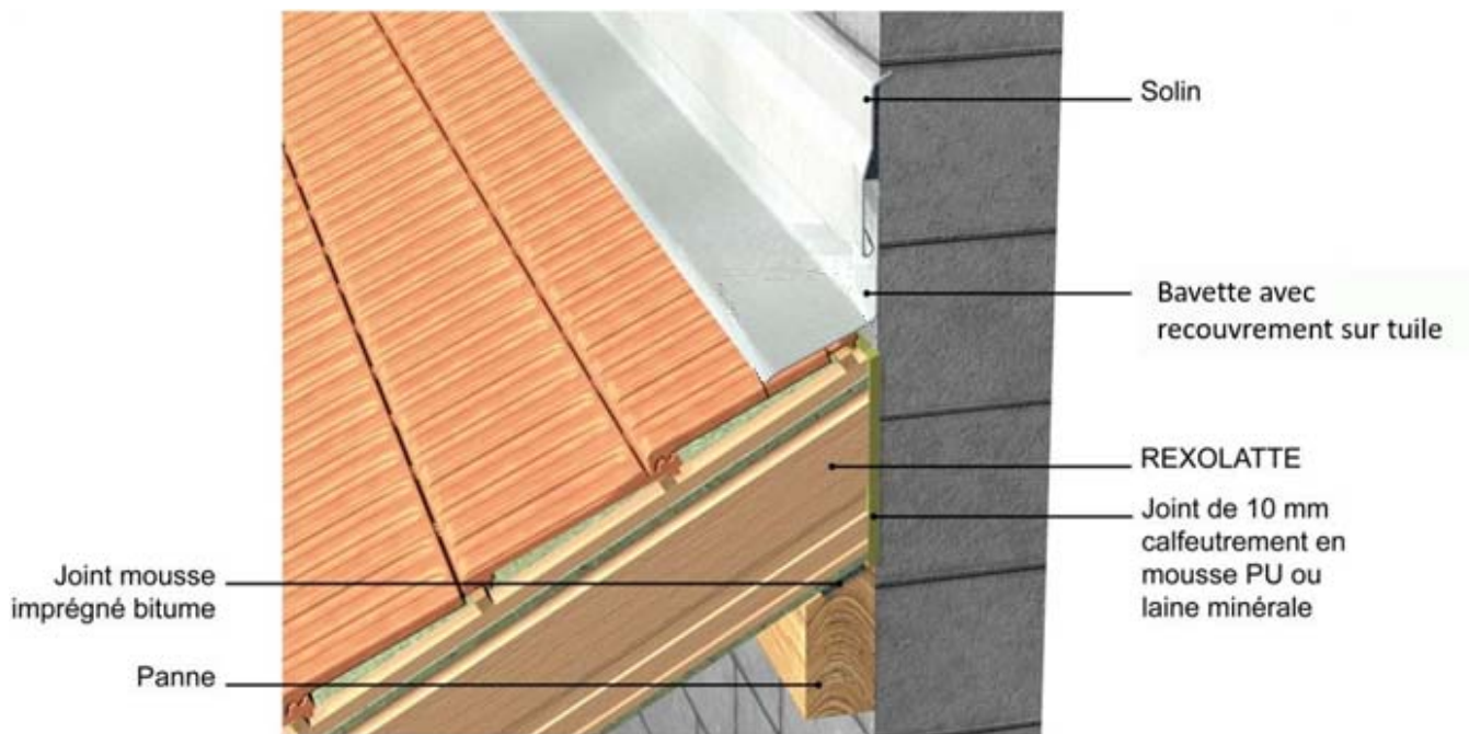
Figure 14 – Rive de tête avec dépassement de mur
